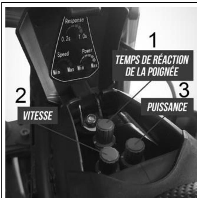
Pour un maximum de sécurité, ce véhicule comprend des éléments de bridage et agit sur **3 variables**. Ces éléments sont à configurer comme des potentiomètres derrière le guidon devant la selle.
