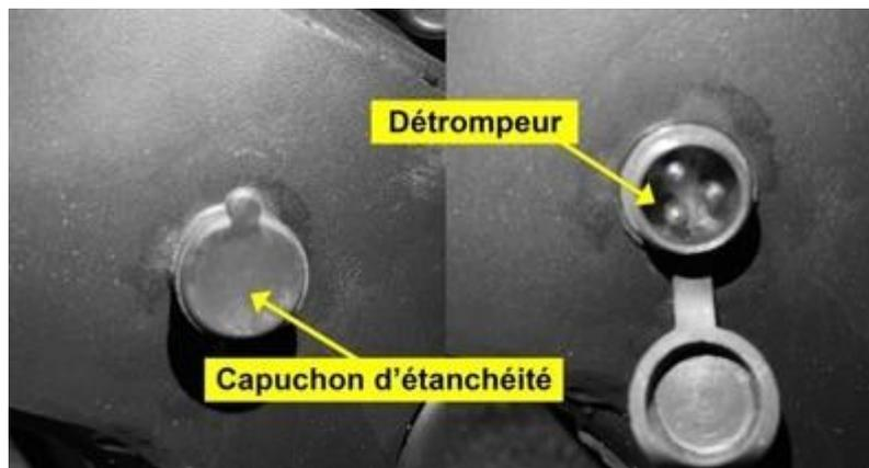
Le connecteur de charge est placé sur le cadre au-dessus de la batterie côté levier de frein arrière. Avant toute charge, vérifiez qu'aucun corps étranger ne s'est inséré dans le connecteur de charge. Il doit être sec et parfaitement propre avant de brancher le chargeur fourni par la marque. Après chaque charge ou utilisation, vérifiez que le capuchon d'étanchéité soit remis dans sa position initiale.
