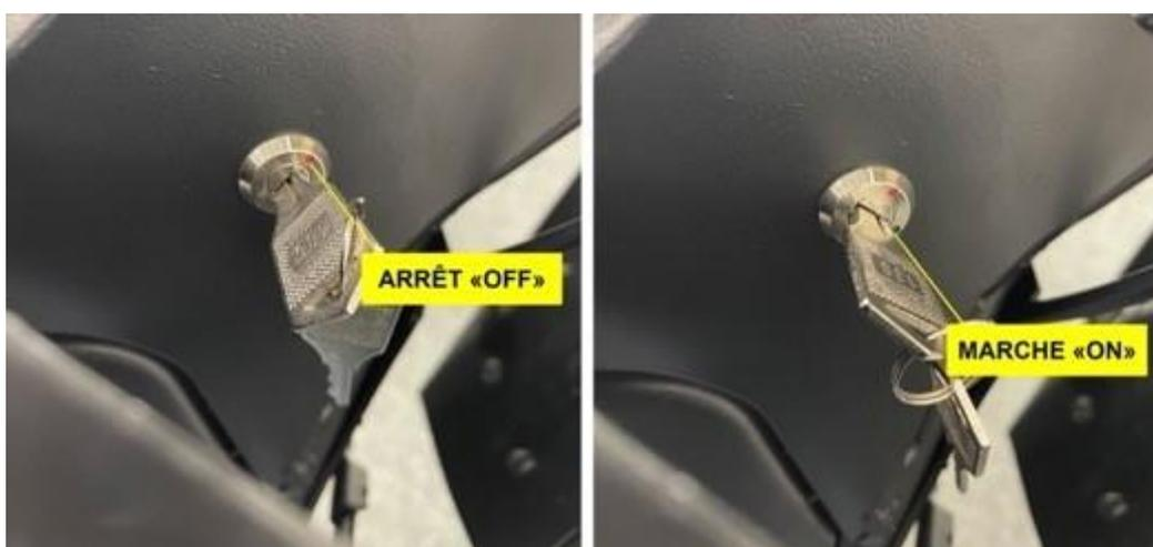
Le contacteur est placé sur le côté droit du cadre du véhicule. La clé est indispensable pour l'utilisation de la moto. **2 positions** :
